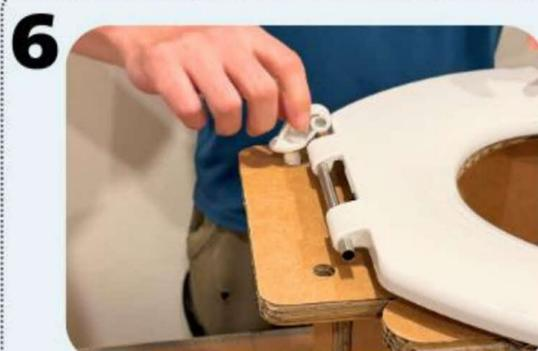
土台の2つのネジ穴に通るように、樹脂製便座の固定ネジ(E)を差し込む。
